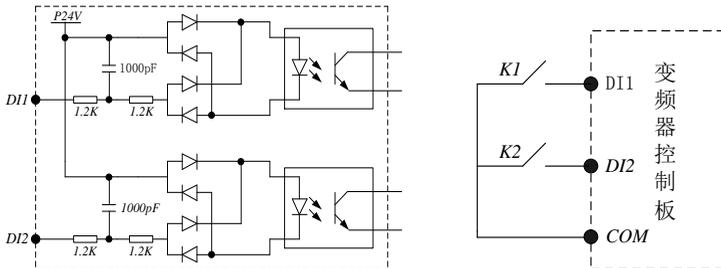
数字量输入回路控制板上的线路图
