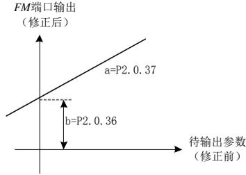
修正后输出  $Y=aX+b$  ( $X$  表示待输出的运行参数,  $a$  为输出增益,  $b$  为输出偏置)
